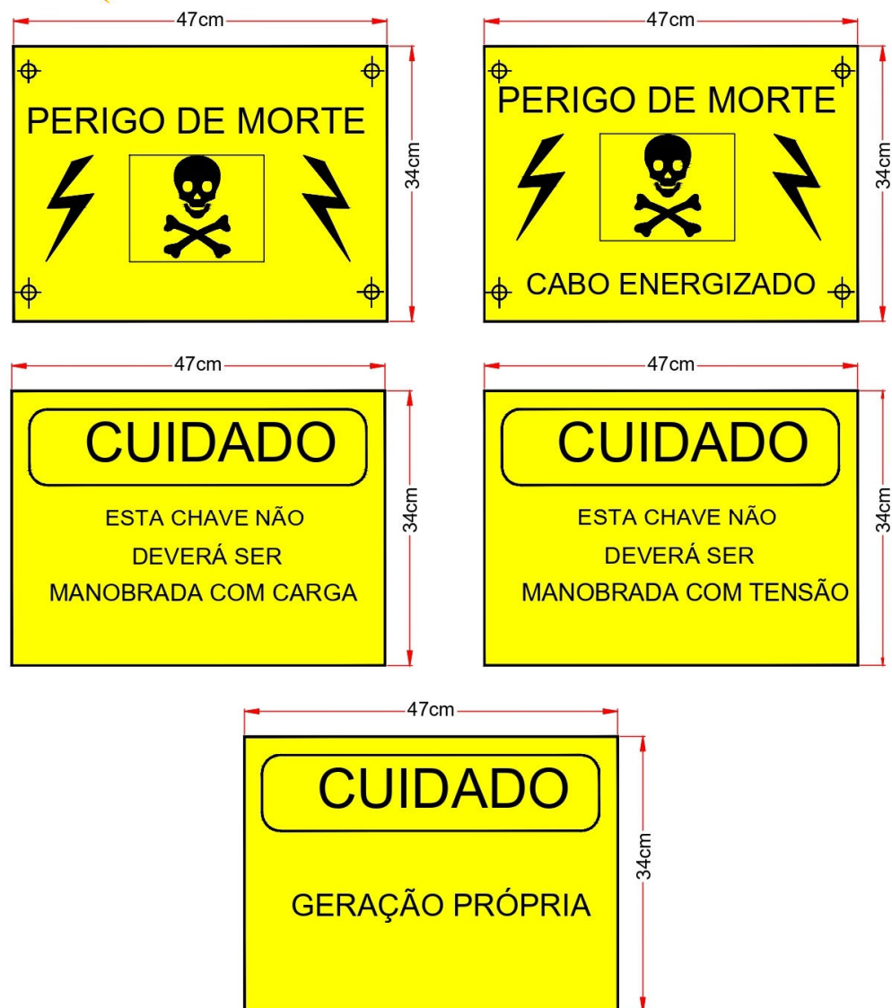
Figura 6 – Placa de identificação
