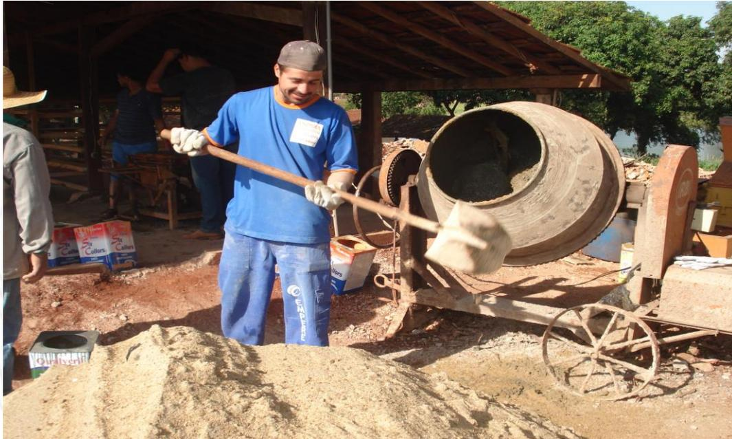
Através da Olaria, as famílias contribuem para a confecção dos pavers na quantidade necessária, a Prefeitura Municipal disponibiliza gratuitamente o Material para a produção como energia para os equipamentos, areia, cimento e RCC triturado para misturar na betoneira e a orientação para a fabricação dos blocos, que são chamados pavers ecológicos.
