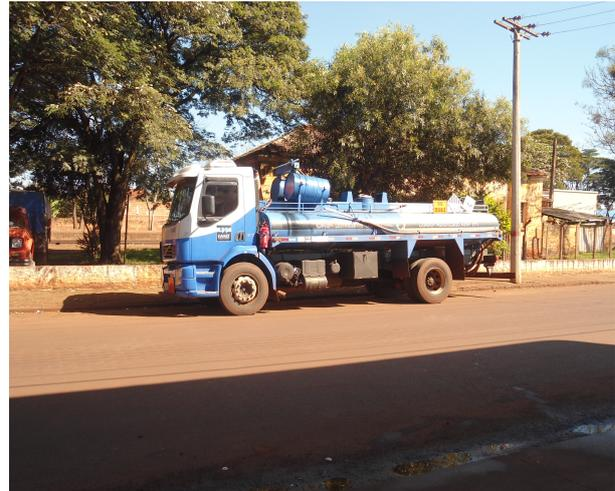
FIGURA 19: Caminhão de coleta de resíduos de óleos lubrificantes da Lwart em Cândido Mota.
