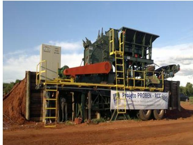
FIGURA 17: Equipamento de beneficiamento de resíduos da construção civil.
